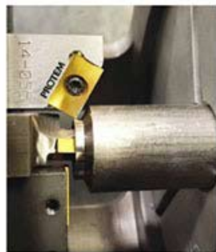
J-viisteen ja sisäpuolisen kevennyksen koneistusta super duplex -putkelle.
